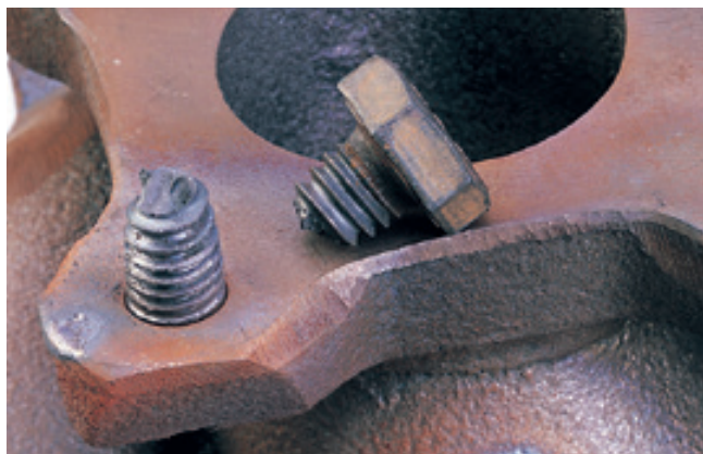
Die Schraube hat sich im defekten Gewinde festgesetzt.
