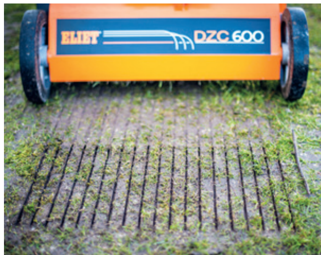
Die Messerwelle, die vorne in der Maschine angebracht ist, fräst Rillen von 10 bis 15 mm Tiefe in die Rasenerde und schafft so das Saatbett für den Grassamen. Die Samen werden angeblasen und landen genau in den Rillen.
