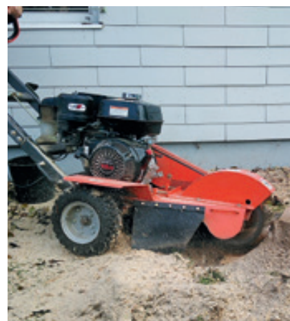
Links: Dieser abgestorbene Baum soll entfernt werden. Rechts: Nach dem Fällen bis auf den Baumstumpf nähert man sich mit der Wurzelstockfräse, fixiert diese und beginnt mit dem seitlichen Schwenken. Zurück bleibt ein lockeres Erde-Holzfasergemisch.
