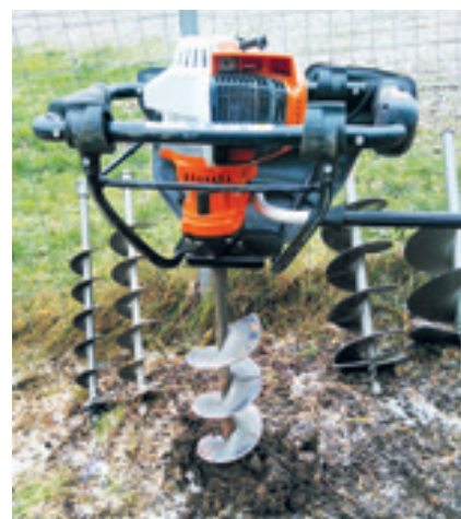
Benzinbetriebener Erdbohrer in Aktion
